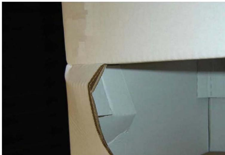
**FIGURA 7.** Modo de falha durante ensaio de pilha. Esta falha nunca acontece no ensaio de caixa única e raramente acontece em ensaios de unidades de carga.
