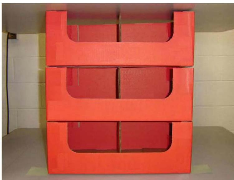
**FIGURA 3.** Pilha de caixas estruturalmente assimétricas.
