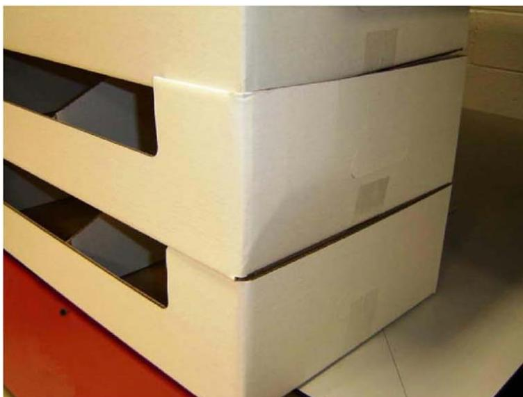
**FIGURA 6.** Resistência à compressão = 696 lbf (28,8% menor do que a Figura 5). Observe o afundamento entre as duas caixas superiores, mesmo após a remoção da força de compressão.
