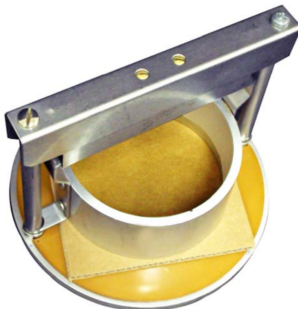
Figura 2. Corpo-de-prova montado no dispositivo de Cobb.
