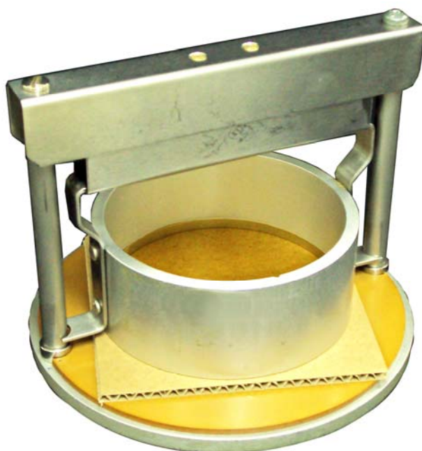
Figura 3. Corpo-de-prova em contato com água no dispositivo de Cobb.
