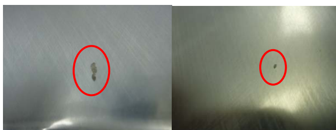
Ilustração de corrosão na face interna de latas de alumínio (SOARES, 2013).
