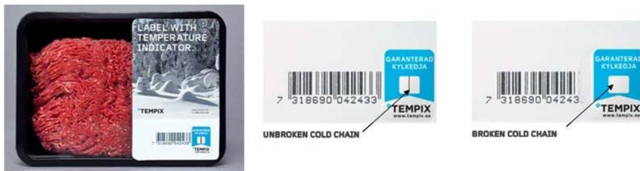
Figura 3. Indicador de tempo-temperatura: aumento de temperatura leva à difusão de substância que afeta leitura do código de barras e impede a compra de produto alterado.
