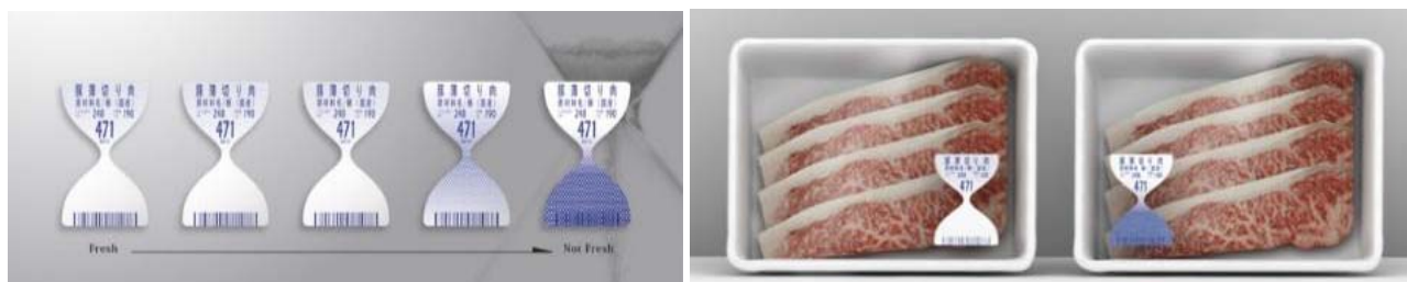
Figura 11. Etiquetas To-Genkyo refletem a qualidade de produtos cárneos em função da concentração de amônia no espaço livre da embalagem.
