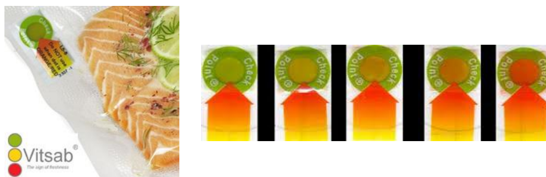
Figura 4. ITT CheckPoint: enzima e substrato são mantidos em compartimentos separados até o momento de ativação, quando entram em contato pela quebra mecânica da divisória entre estas substâncias.
