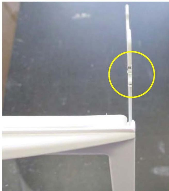
**FIGURA 4.** Exemplo de dano observado no transporte real para comparação com os ensaios de laboratório.
