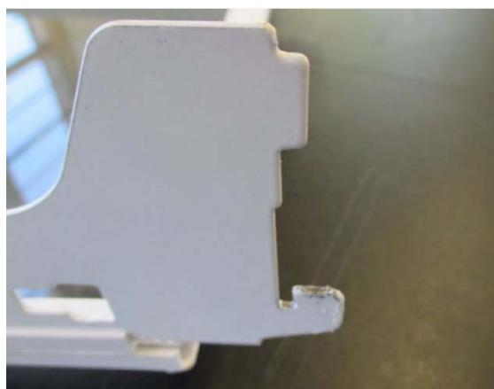
**FIGURA 7.** Exemplo de dano na prateleira ao final do ensaio de vibração com compressão de tempo.
