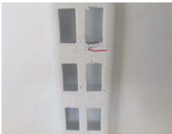
**FIGURA 6.** Exemplo de dano no trilho interno ao final do ensaio de vibração com compressão de tempo.
