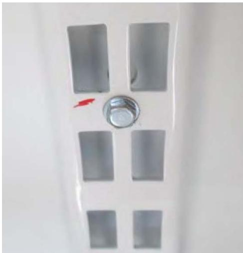
**FIGURA 12.** Exemplo de dano no trilho interno ao final do ensaio > 0,301.
