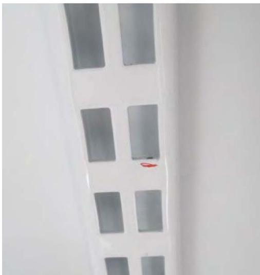
**FIGURA 9.** Exemplo de dano no trilho interno ao final do ensaio 90% → 99%.
