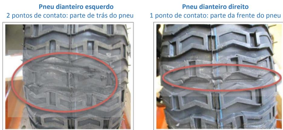
**FIGURA 3.1.** ASTM atual, nível II - 0,52Grms - Dano no pneu.
