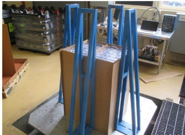
**FIGURA 2.5.** Conjunto de bandejas montadas sobre a mesa de vibração
