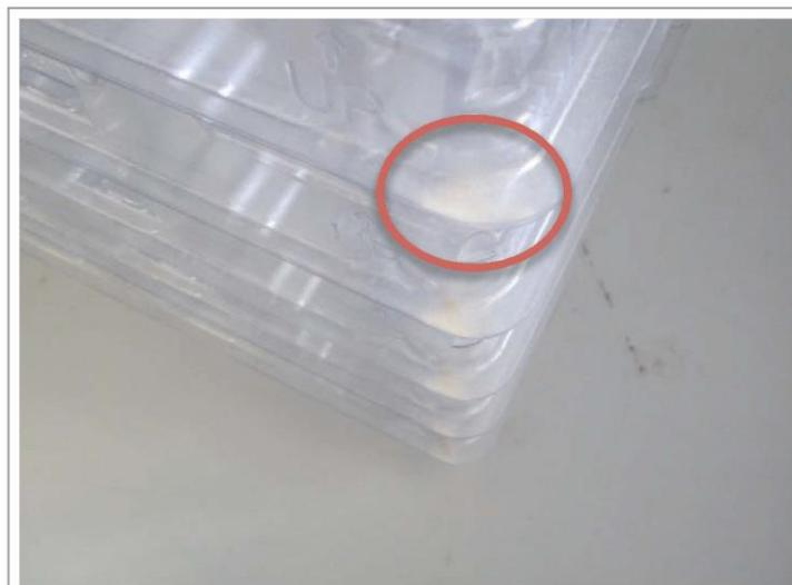
**FIGURA 3.10.** Pó do papelão ondulado no ensaio com perfil atual.
