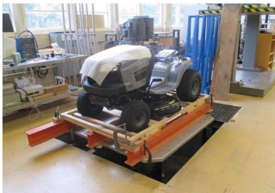
FIGURA 2.2. Montagem do cortador de grama (trator) MTD
