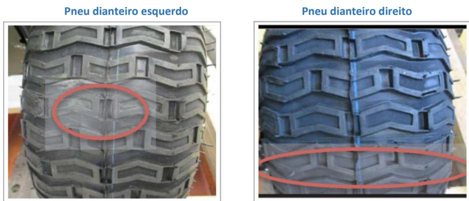
**FIGURA 3.2.** ASTM proposto - Dano no pneu.
