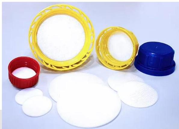
Tampas para embalagens com fechamento a vácuo e para alimentos processados a quente utilizam vedantes/gaxetas à base de borracha ou plastissol (Figura 3), sendo este último composto pela dispersão de uma resina em pó (frequentemente PVC) em um plastificante líquido, que pode ser escoada ou moldada (ROBERTSON, 2013).
