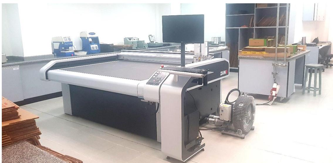
**Figura 3.** Mesa de Corte adquirida pelo Cetea para confecção de caixas de papelão ondulado.
