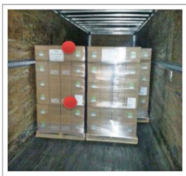
FIGURA 2 - Carga do caminhão com 2 sensores de registro de temperatura. Um deles foi colocado em uma caixa no topo do palete, o outro foi colocado em uma caixa no meio do palete.
