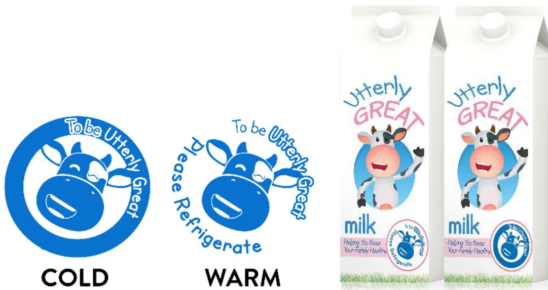
**FIGURA 3.** Indicador reversível de temperatura: tinta termocrômica revela a mensagem quando o produto refrigerado aquece e torna-se vulnerável à deterioração.
