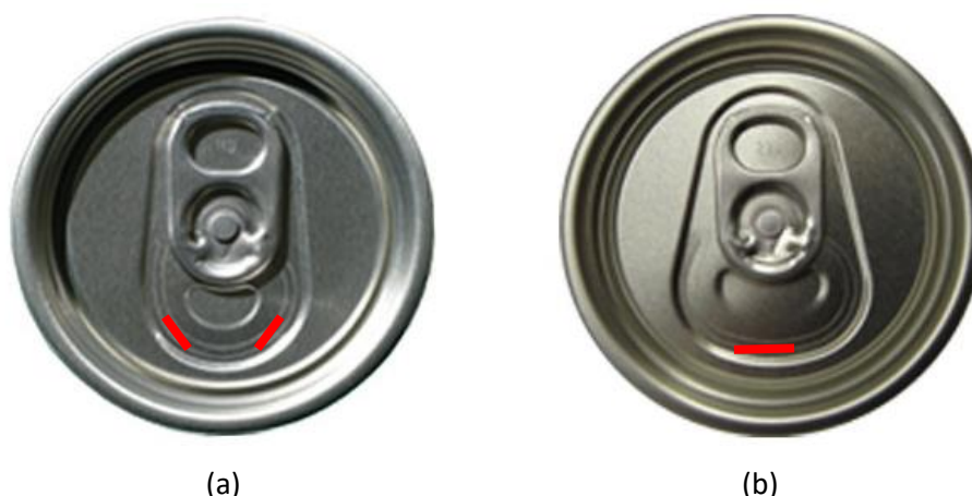
FIGURA 3. Tipos de tampas utilizadas em latas de alumínio padrão (a) e com a região da abertura ampliada ( LOE ) (b) com indicação das regiões com probabilidade de falha por SCC (ASSEM, 2017).
