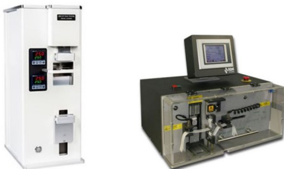
FIGURA 2. Exemplos de equipamentos para determinação do hot tack (Kcen, 2024 e Poli Intrumentos, 2024).
